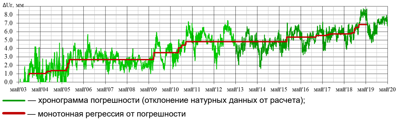
Рисунок Г.1 – Отклонение натуральных данных от расчетных в радиальных перемещениях гребня центральной секции бетонной арочно-гравитационной плотины, мм
