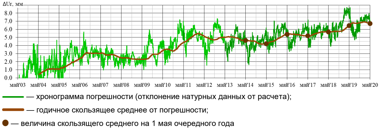
Рисунок Г.1 – Отклонение натуральных данных от расчетных в радиальных перемещениях гребня центральной секции бетонной арочно-гравитационной плотины, мм
