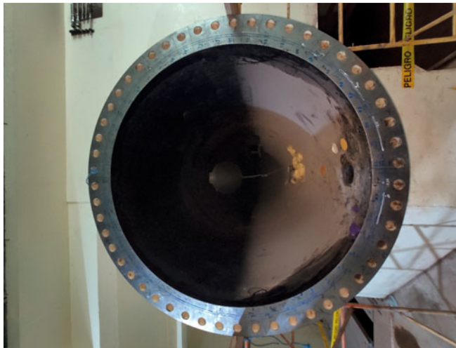
Рис. 1. Входной фланец спиральной камеры гидротурбины
