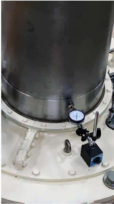
Рис. 7. Микрометрический индикатор часового типа на магнитной стойке для замера биения вала гидротурбины
