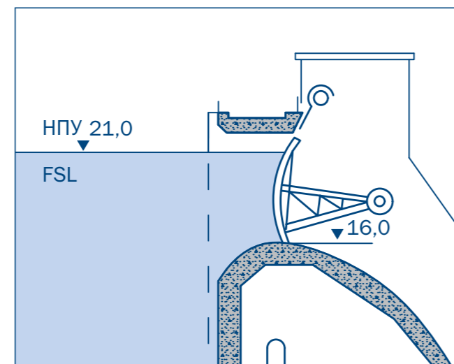
Водосливная секция Spillway section
